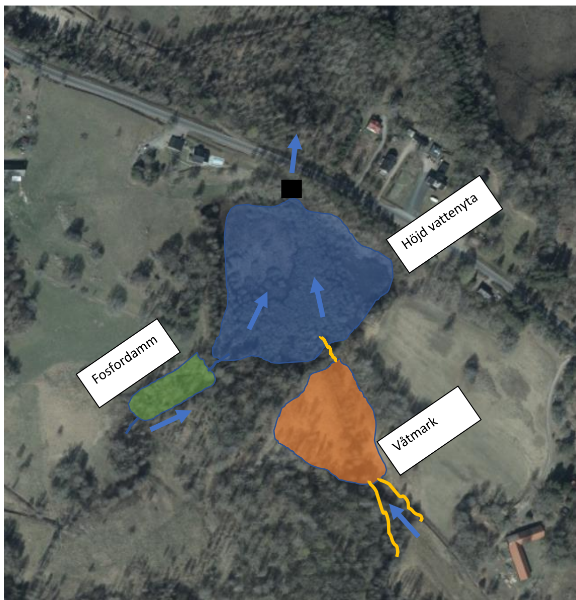
Figur 16. Finngölens yta skulle kunna höjas med 0,5 m så att vattnet står kvar längre på året. I väster kan en fälla anläggas i diket som kommer från sydväst och i diket från söder kan en våtmark anläggas. Högst prio har höjd yta av Finngölen då man redan där får en ökad vattenvolym och en ökning av näringsupptaget. Men alla tre åtgärder kan tillsammans ge ännu större effekt för upptag och biologisk mångfald.
